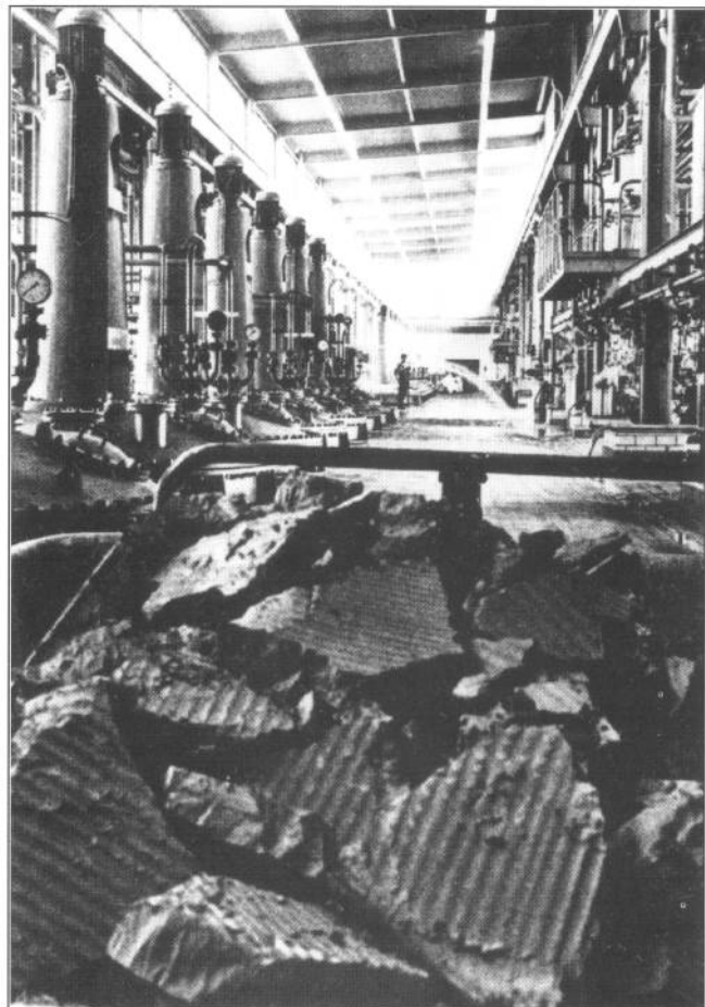
Abb. 4: Übersichtlich ist die Folge der Kessel in einer modernen Azo-Farbenfabrik - Im Vordergrund liegen die Farbstoffe vor dem Trocknen und Mahlen
